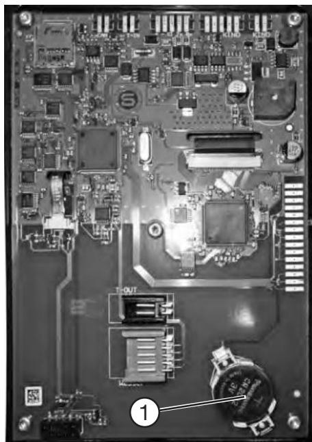
Retro della scheda a circuito stampato del display TFT
